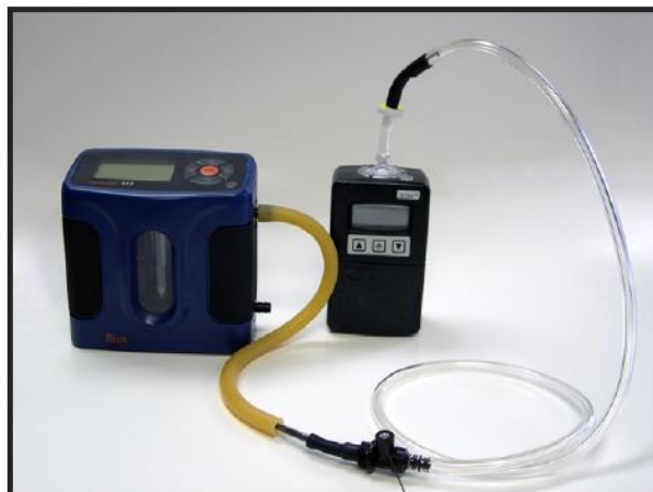
Nastavte průtok pomocí šroubu umístěného na držáku trubiček.
