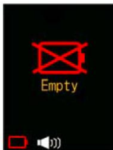
Obr. 12 Úplné vybití akumulátoru
