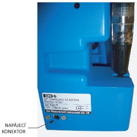
Obr. 13.22 Připojení nabíjecí stanice ke zdroji napájení.
