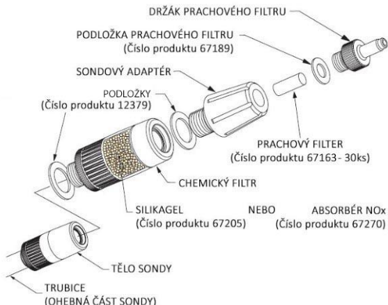
Obr. 13.4 Vyjmutí chemického filtru
