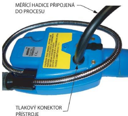
10.3 Měřicí hadice připojená k tlakovému konektoru
