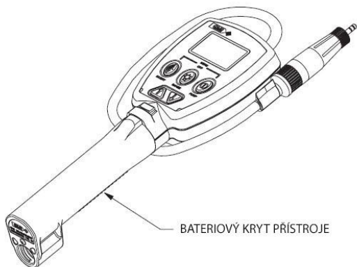
Obr. 13.10 Umístění baterií v přístroji GT Series
