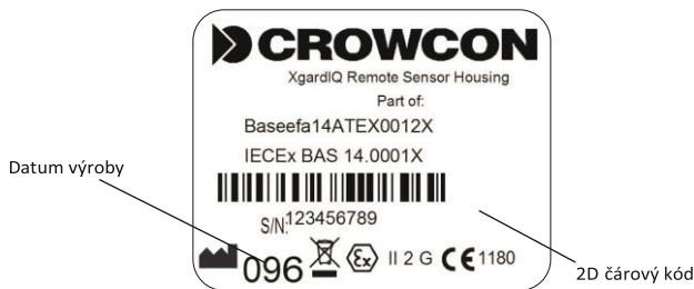
Diagram 7: Štítek odděleného krytu na senzor
