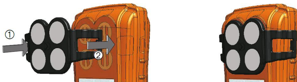
Obr. 6: Instalace externího nástavce s filtry
