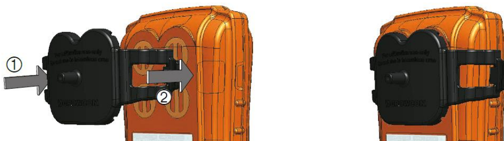
Obr. 5: Instalace kalibračního nástavce
