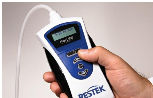
Obrázek 5: Displej zobrazuje naměřenou hodnotu průtoku.
