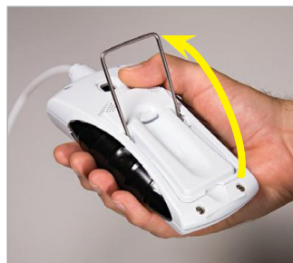
Obrázek 2: Před otevřením dvířek baterie zvedněte drátěný stojan.
