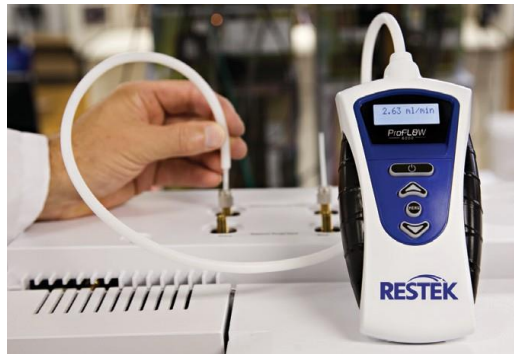
Obrázek 5: Displej zobrazuje naměřenou hodnotu průtoku.
