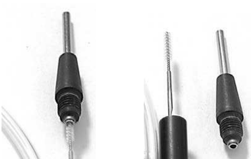
Obrázek 2 – čištění měřící sondy kartáčkem
