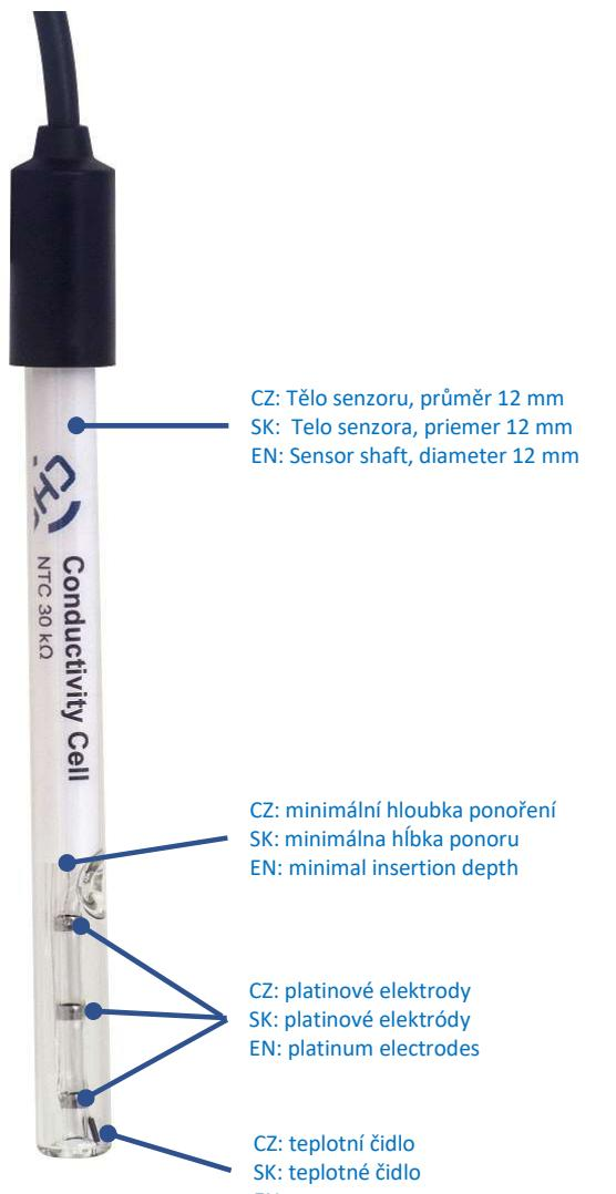
CZ: Tělo senzoru, průměr 12 mm
