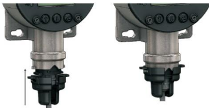
Diagram 13: Instalace kabelové úchytka k převodníku
