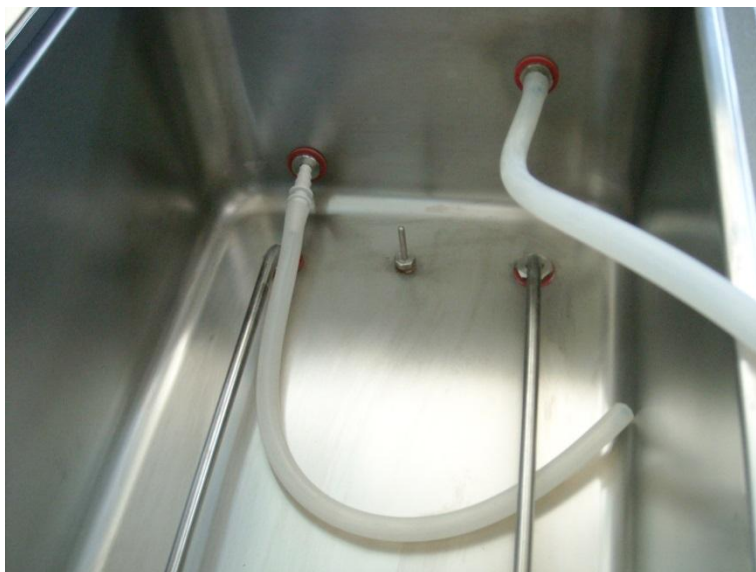
Obr. 5 – Použití vypouštěcí sady u lázní se zabudovaným čerpadlem
